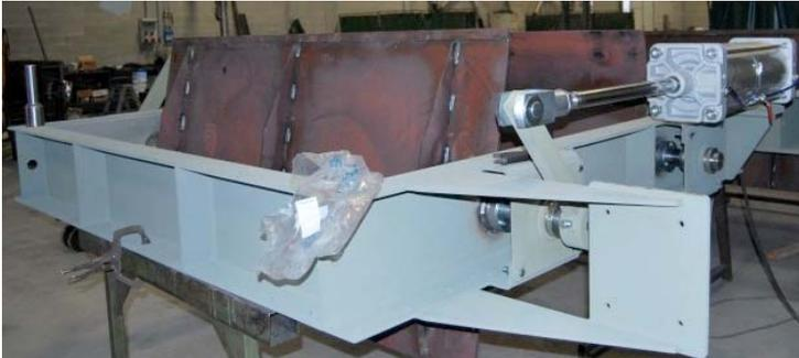
Produciamo serrande di regolazione per basse o alte temperature dei gas con speciali rivestimenti in ceramica o in acciaio speciale anti usura e con tenute fino al 99%
